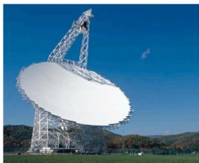
Le Green Bank Telescope (GBT) (États-Unis) est un radiotélescope de 110 m de diamètre qui permet de capter des photons invisibles pour nos yeux. Le rayonnement radio s'étend du millimètre au kilomètre. À titre d'exemple, le GBT est sensible aux ondes de longueur d'onde de 10 cm, comme celles utilisées pour les téléphones portables. C'est pour cette raison qu'il est interdit d'utiliser un téléphone portable (ou même un four micro-onde) dans un environnement proche du GBT.
