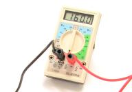
Le Voltmètre et l'Ampèremètre sont deux fonctions d'un même appareil : le **multimètre**. Chaque fonction du multimètre possède **plusieurs calibres** qui sont les différentes positions sur lesquelles on peut placer le sélecteur ; afin d'obtenir la valeur **la plus précise possible**, on utilise le calibre **immédiatement supérieur**, c'est-à-dire le calibre le plus proche, mais supérieur.
